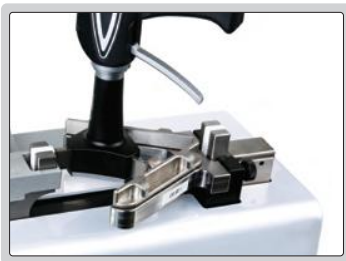
三点内径千分尺对零或校验
